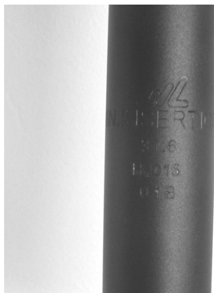
Figure 4 : Marquage d'enfoncement minimal du tube de selle
