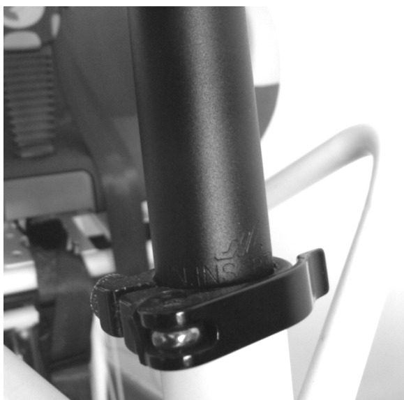
Figure 3 : Respectez l'enfoncement minimal du tube de selle
