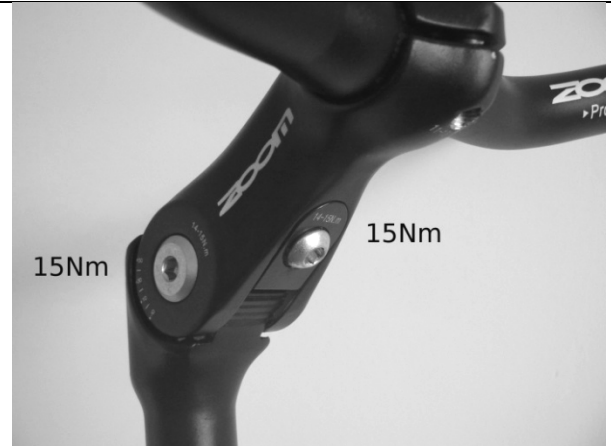
Figure 7 : Inclinaison de la potence, couple de serrage
