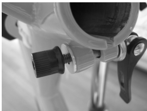
Figure 2 : Blocage de la tige de selle
