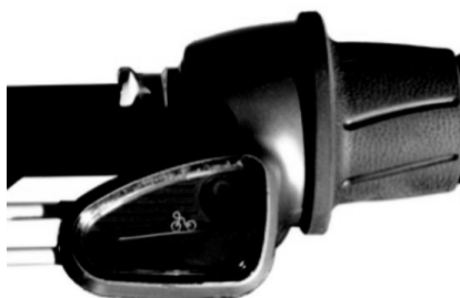
Figure 13 : Dans cette position (« full overdrive »), le rapport de démultiplication est grand. Comme le montre le pictogramme, cette position est utilisée lorsque le terrain est plat ou en descente.
