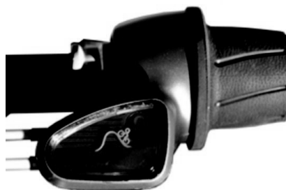
Figure 14 : Dans cette position, le rapport de démultiplication est petit. Cette position est utilisée lorsque le terrain est en montée, lorsqu'il devient difficile de pédaler en gardant une cadence de jambes correcte.
